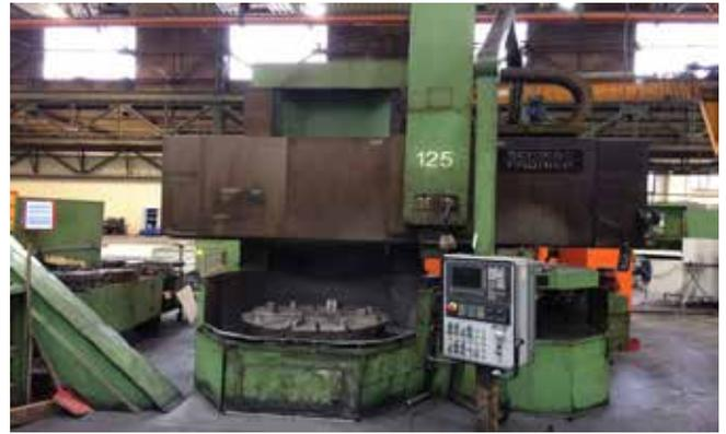
Pos. 365 1 CNC Einständer-Karusselldrehmaschine
