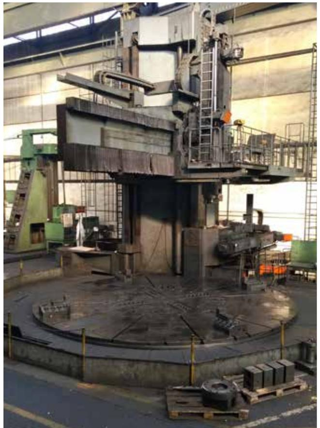
Pos. 425 1 CNC Einständer-Karusselldrehmaschine
