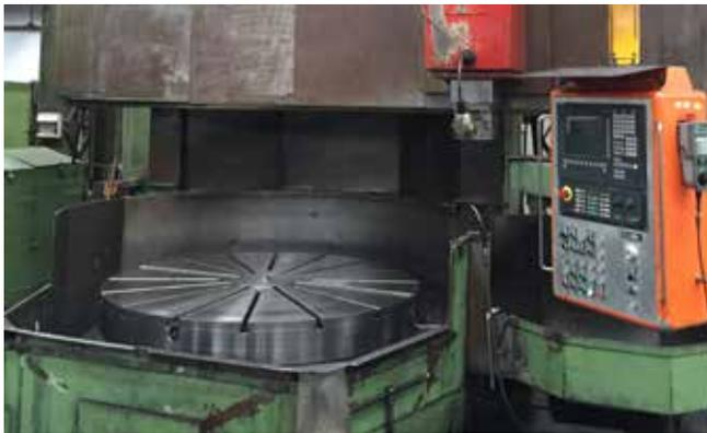
Pos. 377 1 CNC Doppelständer-Karusselldrehmaschine
