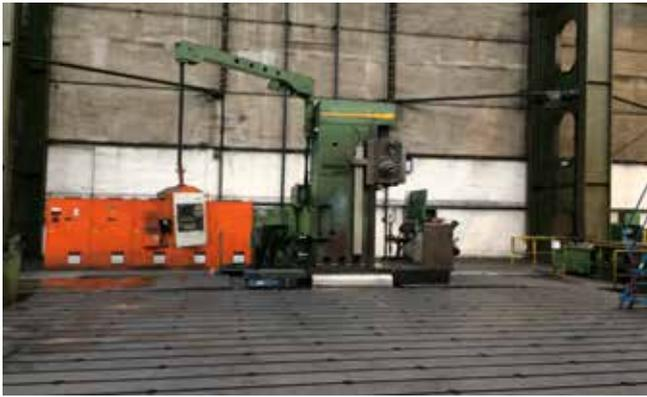
Pos. 411 1 CNC-Bohrwerk
