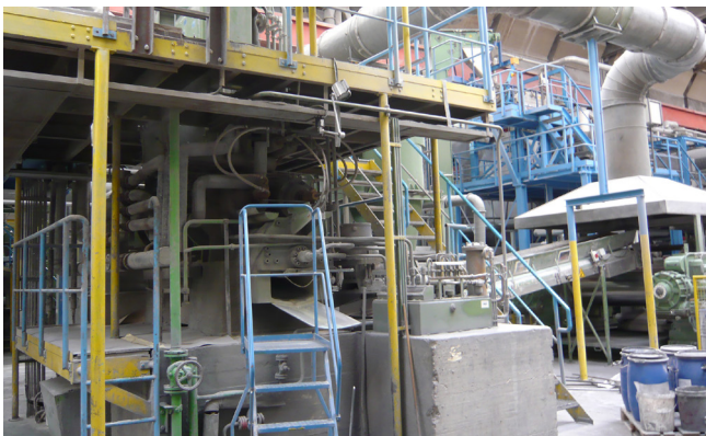
Pos. 362 1 Innenmischer (Doppelwellenkneater) Werner & Pfleiderer GK 100 U 1 Internal mixer (double shaft kneader) Werner & Pfleiderer, GK 100 U
