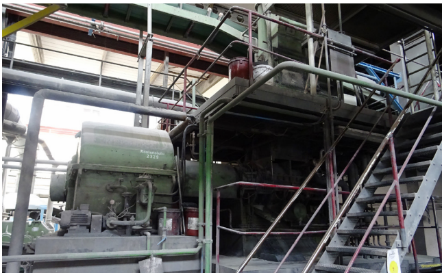
Pos. 352 1 Innenmischer (Doppelwellenkneater) Werner & Pfleiderer, GK 100 1 Internal mixer (double shaft kneader) Werner & Pfleiderer, GK 100
