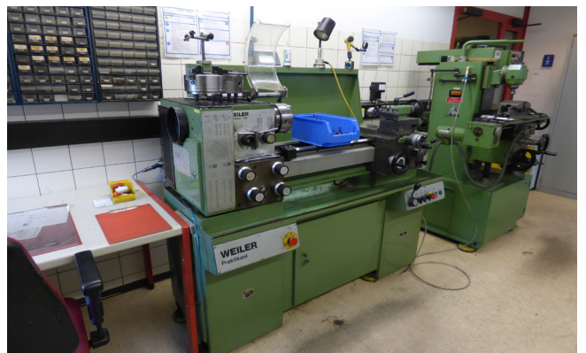
Pos. 342 1 L&Z Spindeldrehmaschine WEILER Praktikant 160 1 L&Z spindle lathe WEILER Praktikant 160
