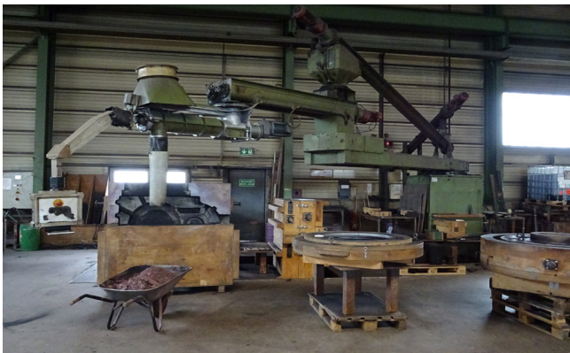
Pos. 27 1 Sandmischer Kernmacherei WEBAC IM10, Bj. 2007 1 Sand mixer core shop WEBAC IM10, YOM 2007
