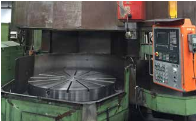
Pos. 377 1 CNC Doppelständer-Karusselldrehmaschine 1 CNC Double-column Vertical Lathe
