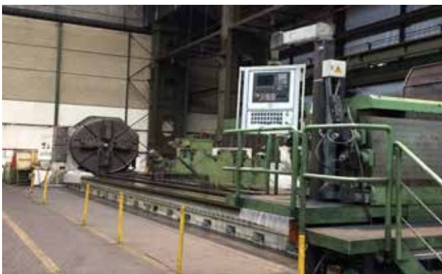
Pos. 406 1 CNC Schwerdrehmaschine 1 CNC Heavy-duty Lathe
