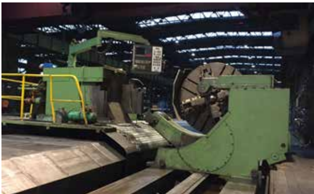
Pos. 398 1 CNC-Schwerdrehmaschine 1 CNC Heavy-duty Lathe
