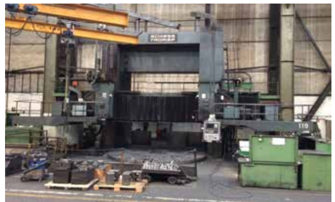
Pos. 422 1 CNC Doppelständer-Karusselldrehmaschine 1 CNC Double-column Vertical Lathe
