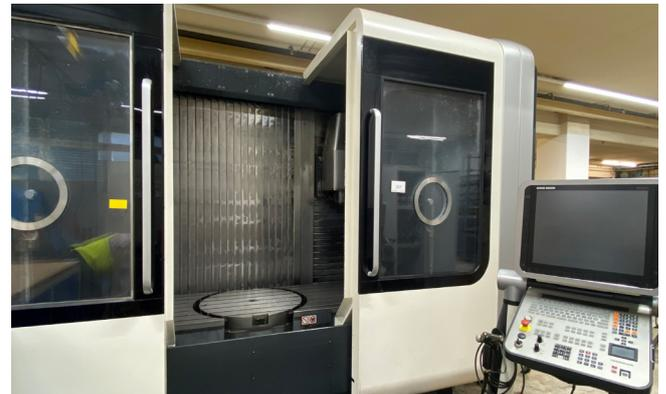
Pos. 257 1 CNC-Fahrständerfräsmaschine DECKEL MAHO DMF180/7, Bj. 2015
