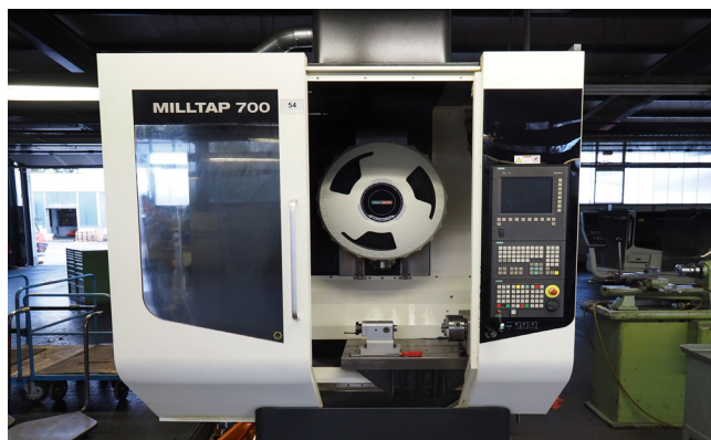
Pos. 54 1 Kompaktbearbeitungszentrum DMG / MORI SEIKI Mill-Tap 700, Bj. 2012 1 Compact machining center DMG / MORI SEIKI Mill-Tap 700, YOM 2012
