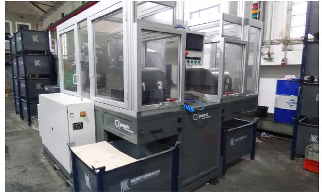
Pos. 154 1 Gewindeformanlage PRONIC ATM, Bj. 2023
