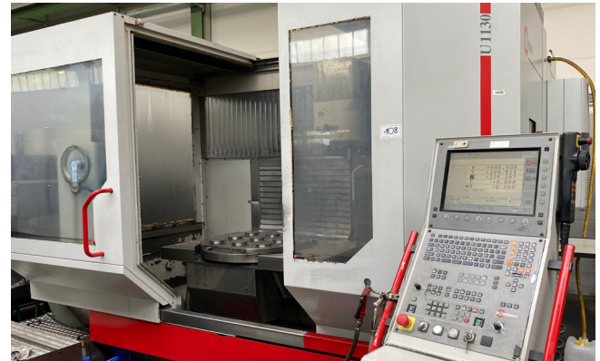
Pos. 108 1 Universal-5-Achs-Bearbeitungszentrum HERMLE U1130, Bj. 2007 1 Universal 5-axis machining centre HERMLE U1130, YOM 2007
