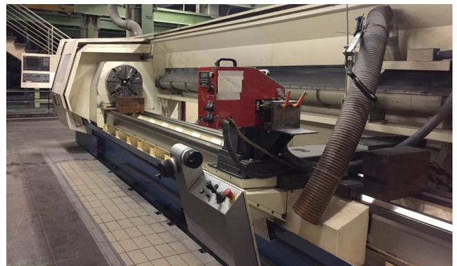
Pos. 41 **1 CNC-Drehmaschine VDF Boehring DUS 1000 ti, Bj. 2001**
