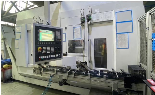
Pos. 4 1 Doppelspindel-Drehmaschine SCHERER FEINBAU VDZ 220 DS, Bj. 2012
