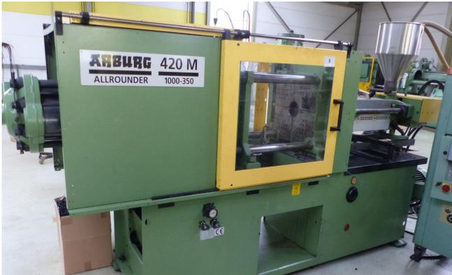
Pos. 8 1 Kunststoffspritzgussmaschine ARBURG ALLROUNDER 420M 1000-350
