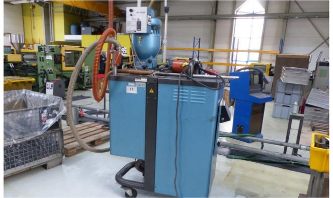
Pos. 17 1 Granulatrockner LABOTEK 120,00 DDM
