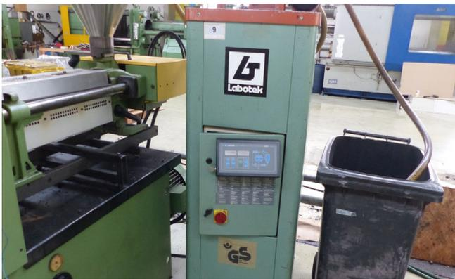
Pos. 9 1 mobiler Granulatrockner LABOTEK BGT 4-DDM
