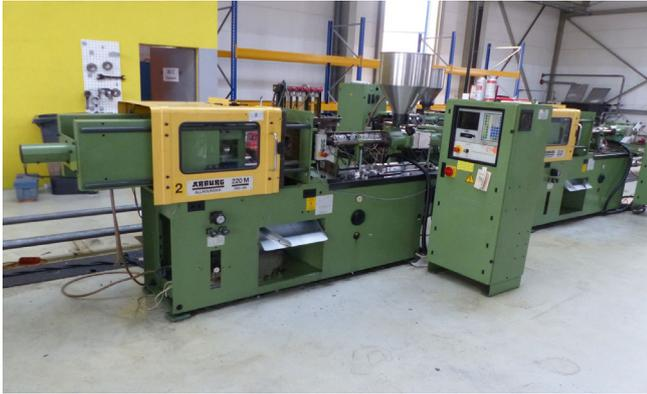
Pos. 2 1 Kunststoffspritzgussmaschine ARBURG ALLROUNDER 220 M 350-90
