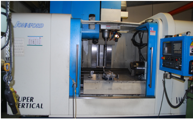
Pos. 23 1 Vertikales Bearbeitungszentrum Johnford, Typ VMC-1300HD 1 Vertical machining centre
