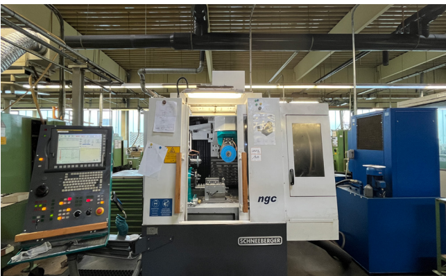
Pos. 148 15-Achs-CNC-Werkzeugschleifmaschine SCHNEEBERGER normaNGC 15-axis CNC tool grinding machine SCHNEEBERGER normaNGC, YOM 2015
