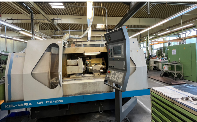
Pos. 139 1 Außenrundscheifmaschine KELLENBERGER KEL-VARIA UR 175/1000 1 External cylindrical grinding machine KELLENBERGER KEL-VARIA UR 175/1000
