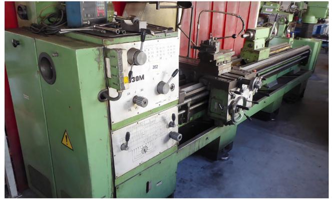
Pos.202 1 L+Z Drehmaschine Fett, Typ Tur630M
