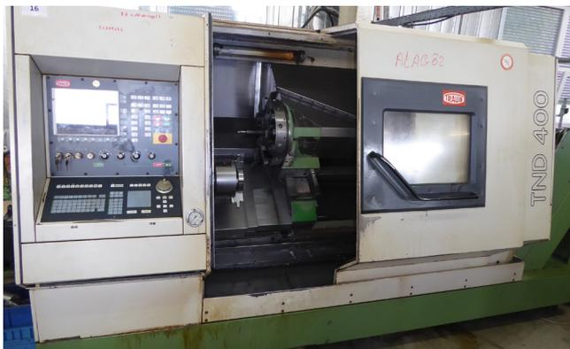
Pos. 16 1 CNC-Drehmaschine 20 Fabr. TRAUB, Typ TND 400, Bj. 19903
