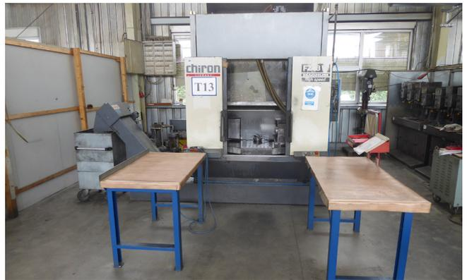
Pos. 24 1 CNC-Vertikal-Bearbeitungszentrum T13 Fabr. CHIRON, Typ FZ 18 W
