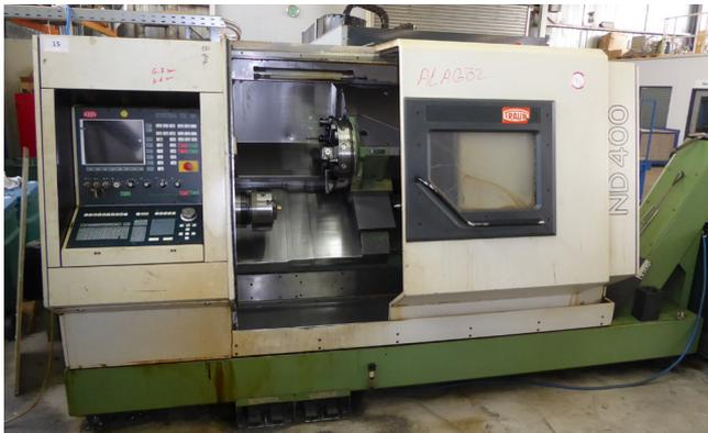
Pos. 15 1 CNC-Drehmaschine 18 Fabr. TRAUB, Typ TND 400, Bj. 1990
