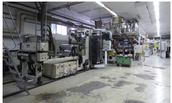
Pos. 5 1 Co-Extrusionsanlage „E 313“ REIFENHÄUSER RH 801-1-100-33V, Bj. 2001 1 Co-extrusion line "E 313" REIFENHÄUSER RH 801-1-100-33V, YOM 2001
