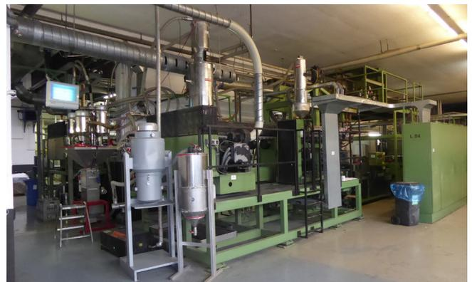
Pos. 18 1 Inline Anlage L04 (Extruder/Thermoform-Maschine) Battenfeld
