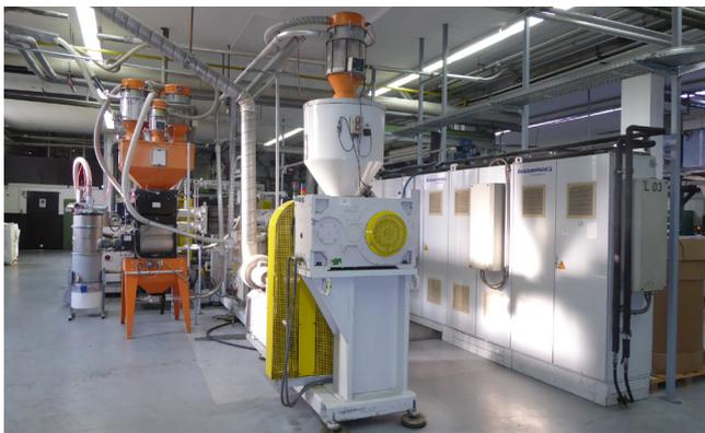
Pos. 1 1 Inline Anlage L03 (Extruder/Thermoform-Maschine) Battenfeld
