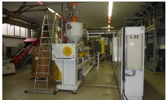
Pos. 12 1 Inline Anlage L02 (Extruder/Thermoform-Maschine) Battenfeld
