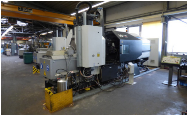
Pos. 64 1 Warmkammer-Druckgießmaschine FRECH W125ZN, Bj. 2019 1 Hot chamber die casting machine FRECH W125ZN, YOM 2019
