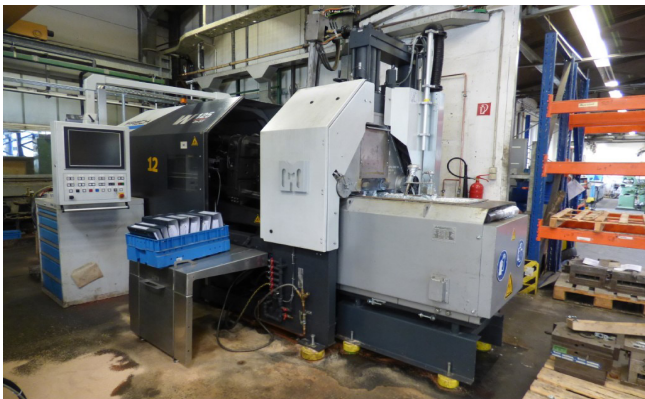
Pos. 80 1 Warmkammer-Druckgießmaschine FRECH W125Zn-ST, Bj. 2019, 1 Hot chamber die casting machine FRECH W125Zn-ST, YOM 2019,
