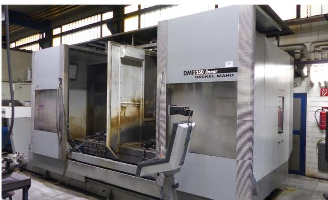
Pos. 57 1 CNC-Fahrständer-Fräsmaschine DECKEL MAHO DMF 250 LINEAR
